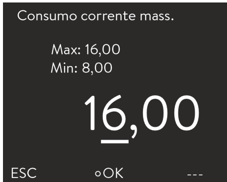
Fig. 45: Impostazione dell'assorbimento di corrente
